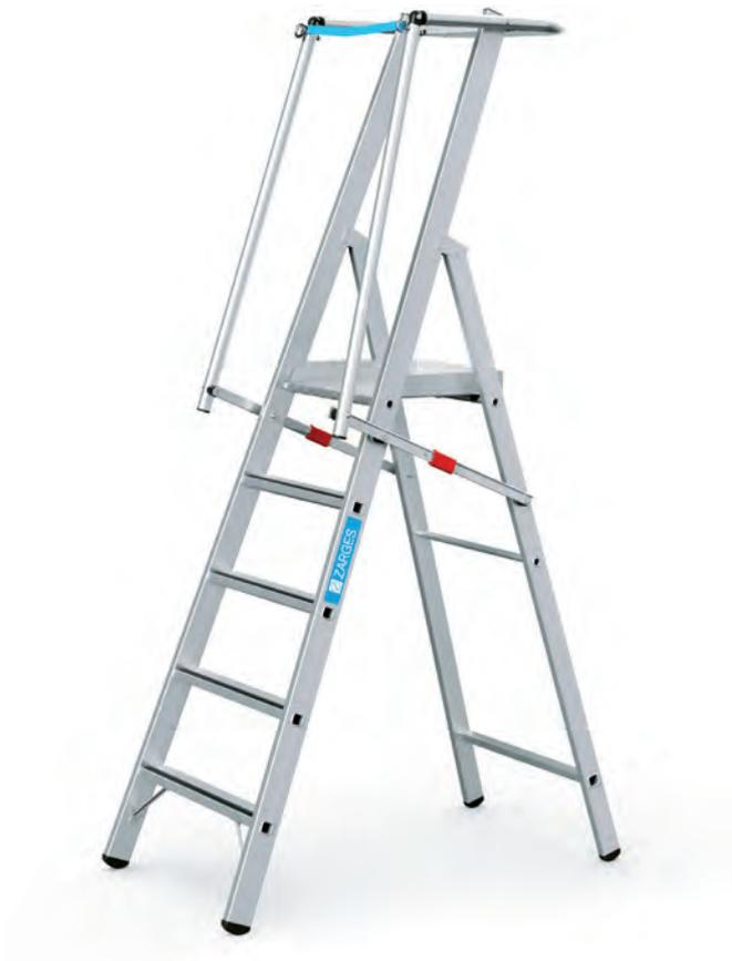
Die gebördelte Stufen-Plattformleiter kann jetzt nachträglich mit Auslegern ausgestattet werden um der EN 131-7 zu entsprechen. Optimale Stabilität durch beidseitige, starre Verbindung mit Druckaussteifung. Platzsparender Transport durch klappbare, eloxierte Handläufe. Leichtes und schnelles Zusammenklappen der Leiter durch Griff an der Plattform.
