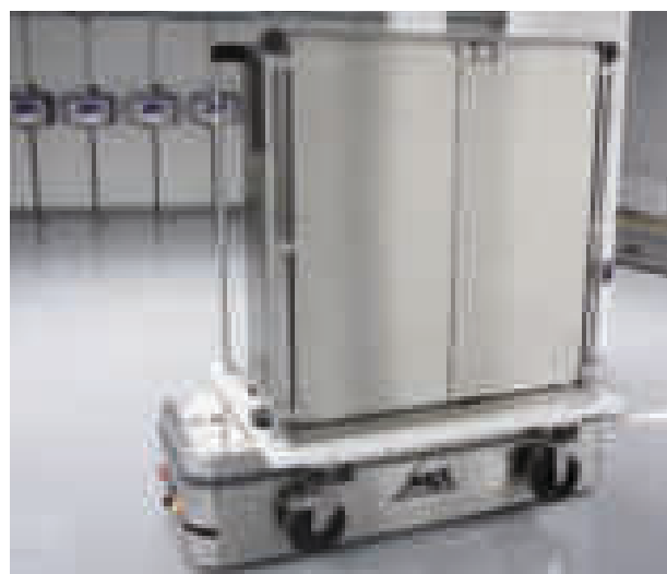
Fahrerloses Transportsystem mit Känguruh-System Transportwagen
