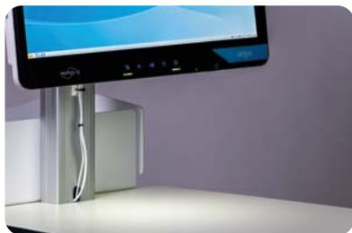
Das Gehäuse des Venus Panel-PC ist vollständig gekapselt. Keine Lüfteröffnungen durch die Flüssigkeit eindringen könnte, kein störendes Kabel, sauber integrierte Akku-Steckplätze. Front- und Korpusdesign sind dicht geschlossen – perfekt für eine gründliche Reinigung als sichere Prophylaxe gegen Kreuzinfektionen.
