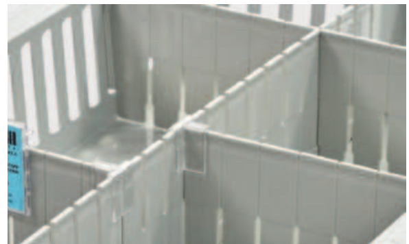
2 T-Stück M1T Mittels der Sollbruchstellen an den Fachteilern können diese auf die gewünschte Länge gekürzt und mit dem T-Stück fixiert werden.
